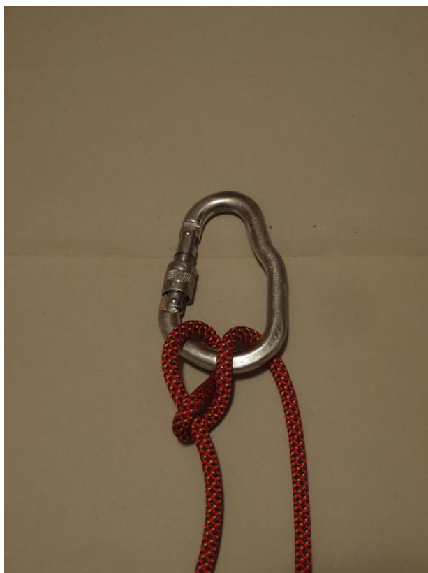
Obr.č.7 – přetočený poloviční lodní uzel
