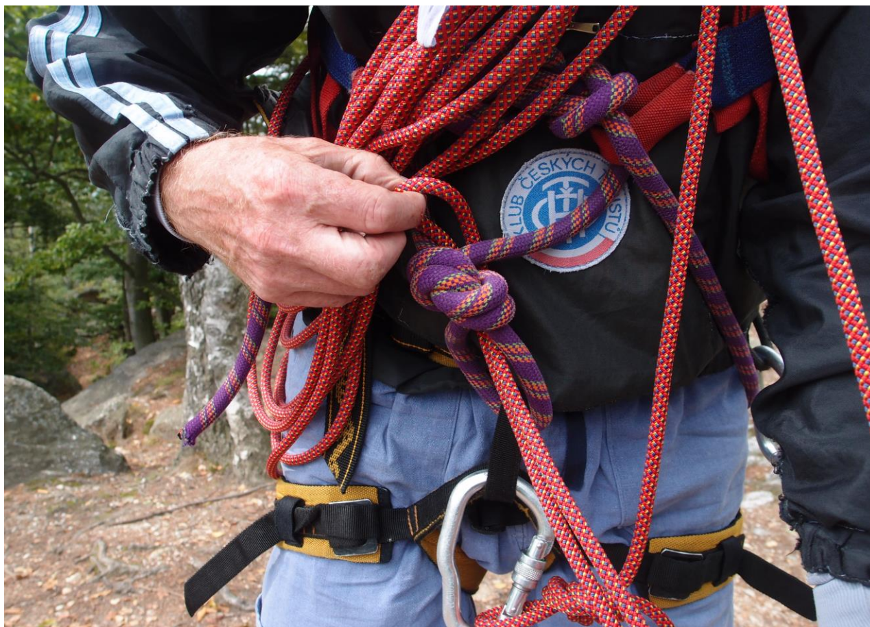
Obr. č.4a – Postup navázání a zajištění zbytku lana vedoucího družstva – krok 1
